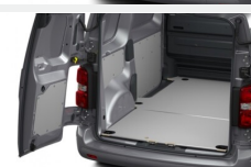
Podłoga drewniana 12mm - pojedyncze drzwi boczne L1 Zabudowy przestrzeni ładunkowej
