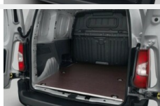
Podłoga ze sklejki (10mm) - (kompatybilne z każdą wersją drzwi przesuwnych) Zabudowy przestrzeni ładunkowej
