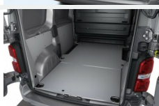
Podłoga drewniana 9mm - L1 Zabudowy przestrzeni ładunkowej
