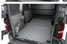
Podłoga drewniana 9mm - L2 Zabudowy przestrzeni ładunkowej
